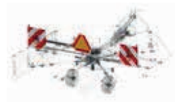
LED verlichting op markeringsborden
